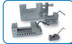
Art. 725 pag. 34 Morse di Precisione per macchine erosione tufo o filo materiale SUS440 HRC58 INOX magnetizzabile
